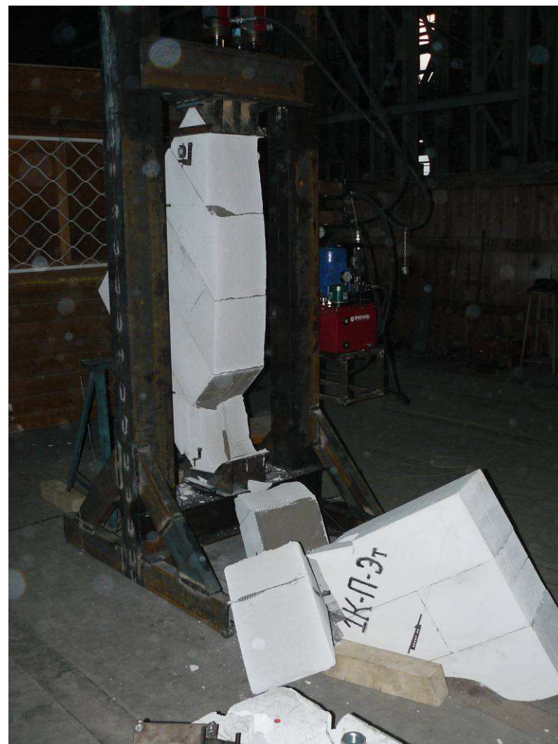
Рис. 3.6а. Характер разрушения образцов, смонтированных на клеевом составе, после испытаний на перекос
