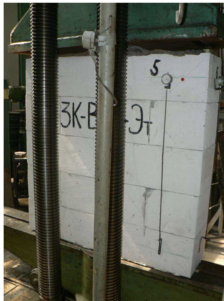
Рис. 3.8. Общий вид до испытания опытных образцов I-ой серии (а) и II-ой серии (б) на центральное и внецентренное сжатие
