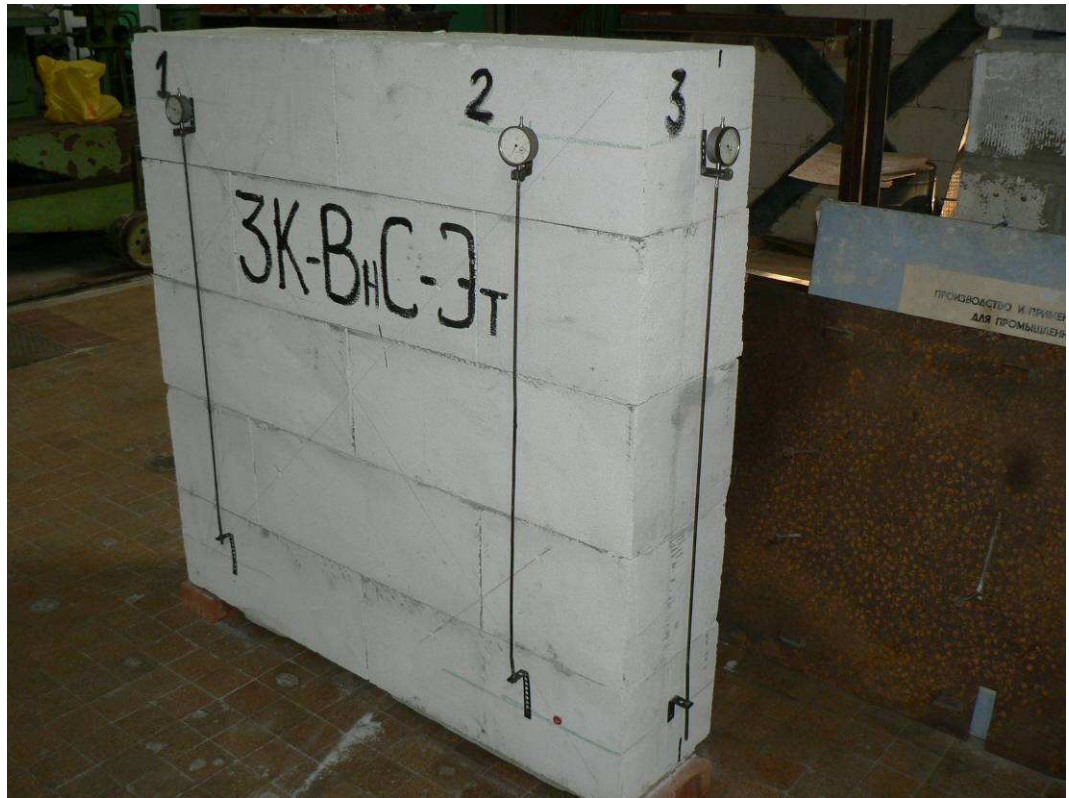
Рис. 2.10. Общий вид опытного образца для испытаний на центральное и внецентренное сжатие
