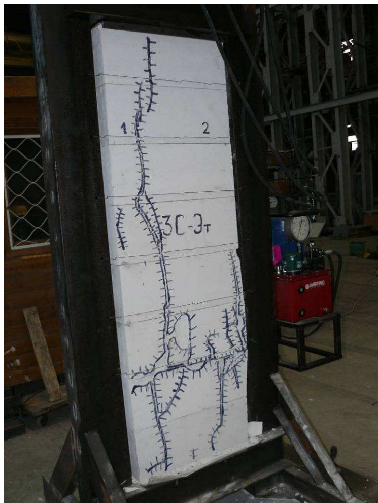
Рис. 3.9. Характер разрушения образцов I-ой серии (а) и II-ой серии (б) на центральное и внецентренное сжатие после испытаний
