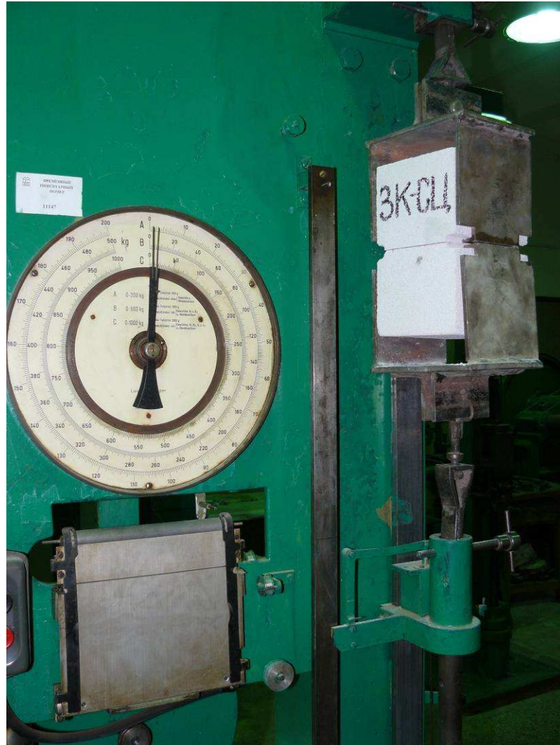
Рис. 3.2. Общий вид установки для испытаний на осевое растяжение
