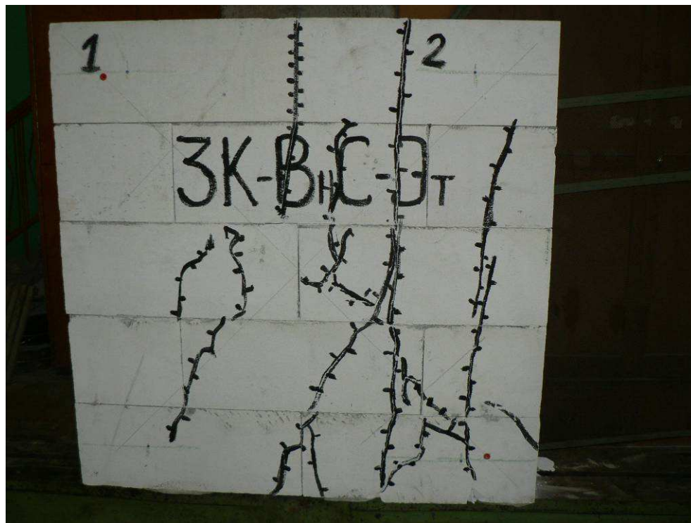
Рис. 3.9. Характер разрушения образцов I-ой серии (а) и II-ой серии (б) на центральное и внецентренное сжатие после испытаний
