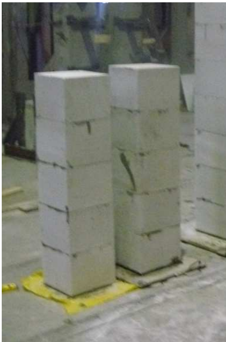
Рис. 2.13. Общий вид опытных образцов для испытаний на изгиб
