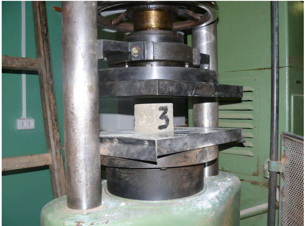
Рис. 2.2. Общий вид образцов-кубов из раствора до и в момент их испытаний на сжатие
