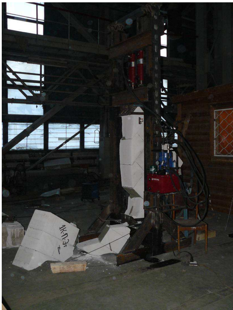
Рис. 3.6а. Характер разрушения образцов, смонтированных на клеевом составе, после испытаний на перекос
