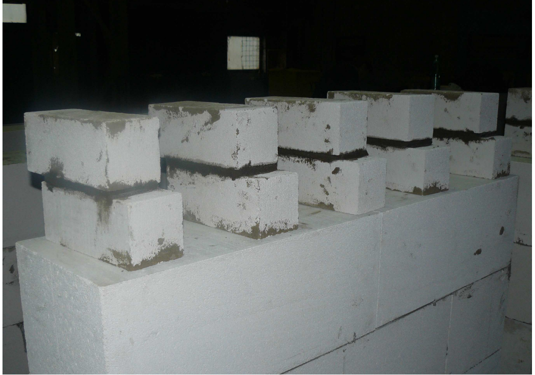
Рис. 2.6. Общий вид образцов для испытаний на сдвиг
