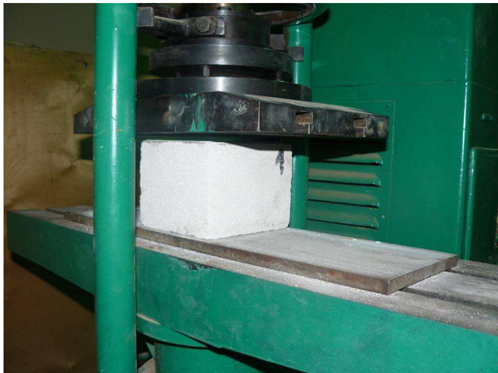
Рис. 2.1. Общий вид образцов-кубов до и в момент испытания их на сжатие
