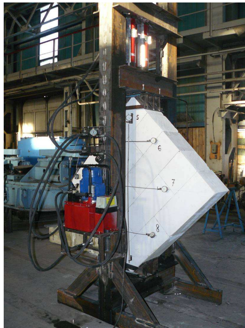
Рис. 3.5. Общий вид образца в прессе до испытаний на перекос
