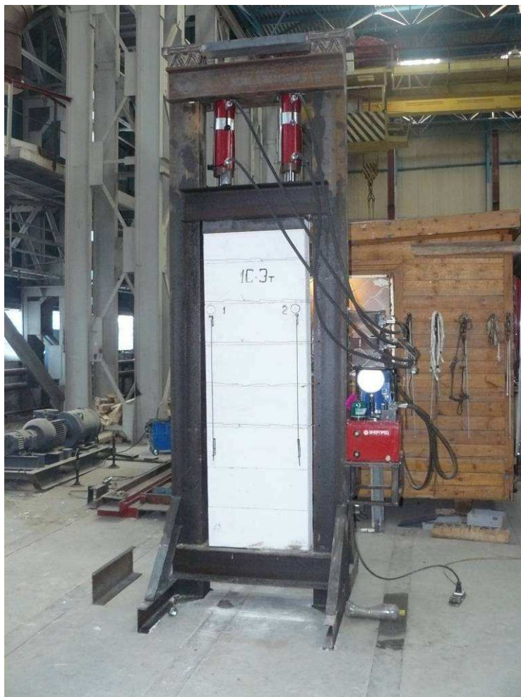
Рис. 3.8. Общий вид до испытания опытных образцов I-ой серии (а) и II-ой серии (б) на центральное и внецентренное сжатие
