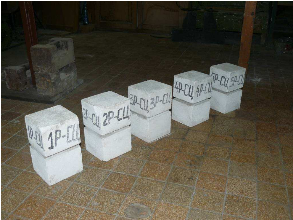
Рис. 2.4. Общий вид образца для испытаний на осевое растяжение
