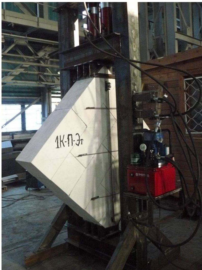
Рис. 3.5. Общий вид образца в прессе до испытаний на перекос
