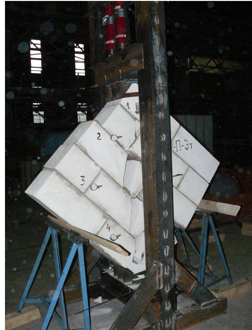
Рис. 3.66. Характер разрушения образцов, смонтированных на цементном растворе, после испытаний на перекос
