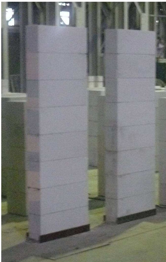
Рис. 2.11. Общий вид опытных образцов стен для испытаний на центральное и внецентренное сжатие
