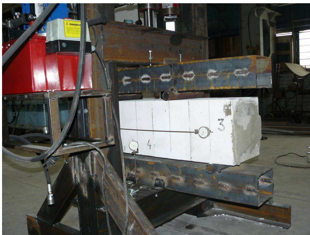
Рис. 3.11. Общий вид опытных образцов до испытания на изгиб
