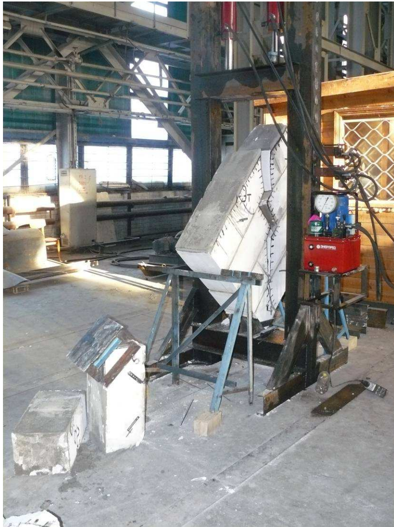
Рис. 3.66. Характер разрушения образцов, смонтированных на цементном растворе, после испытаний на перекос
