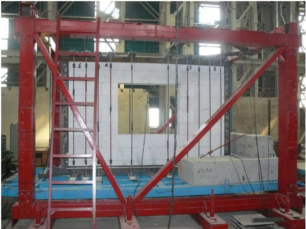
Рис. 4.2. Общий вид виброплатформы с установленным на ней образцом
