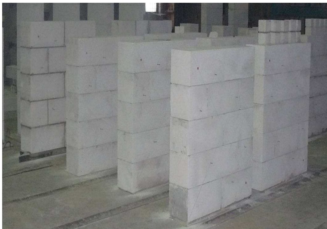
Рис. 2.8. Общий вид опытного образца для испытаний на перекос
